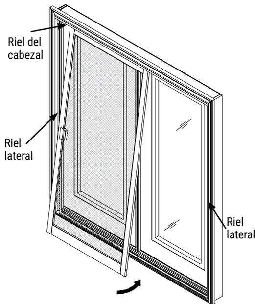
NOTA: para jambas entre 4 9/16" y 5 1/2", agregue un separador (no incluido) de 1/2"x1" al borde vertical de la moldura. Este llenará el espacio entre el riel y la moldura. El separador proporcionará una superficie plana para montar el riel. (representado en la imagen a la derecha)
