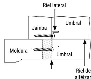
Para una unidad de patio doble con una puerta oscilante, un riel lateral se instala en una jamba (moldura para una unidad de jamba de 4 9/16"). Para una unidad de patio triple con una puerta oscilante, dependiendo de la configuración, un riel lateral se puede instalar en un casquillo del marco o en una jamba lateral (a la moldura para una unidad de jamba de 4 9/16"). Para las unidades de patio antes mencionadas con solo una puerta oscilante, la puerta de mosquitero se instala en el riel externo.
